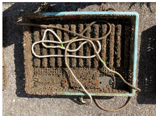
図 4-1：海中暴露約 4 カ月後の試験体の状況
